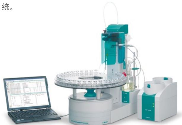
图4. 瑞士万通 851 库仑法卡尔费休水分测定仪和 874 卡氏加热炉样品处理器组成的库仑法卡尔费休滴定系统, 用于固体电池样品的全自动分析。
